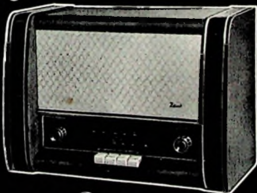
JOTHA- Zeus 12-Kreis-Super (4 AM + 8 FM) mit 4 Drucktasten, 3 Wellenbereiche, 5 Röhren, Oval-Lautsprecher, kontinuierliche Tonblende, 4-Watt-Endstufe, hervorragende UKW-Leistung, hochglanzpoliertes Edelholzgehäuse 420 x 295 x 220 mm Preis: DM 169,50
