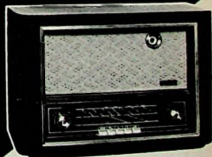
JOTHA- Mercedes 54 Großsuper mit 9 UKW- und 6 AM-Kreisen, 5 Drucktasten, 3 Wellenbereiche, 8 Röhren, überragende UKW-Leistung durch rauscharme 2-Röhren-Hochleistungs-Vorstufe und Ratio-Detektor, großer 6-Watt-Oval-Konzertlautsprecher, 5-Watt-Endstufe, Schwungradantrieb, Magisches Auge, geeicht. UKW-Namenskala, kontin. Tonblende, eingebauter Allwellen-Hochleistungs-Dipol, Anschlüsse für Tonabnehmer u. 2 Lautsprecher, reichverziertes, hochglanzpoliertes Edelholzgehäuse 520 x 345 x 250 mm Preis: DM 299.-
